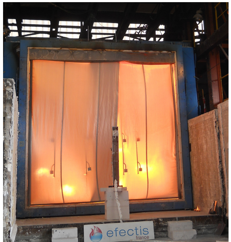
Rideau vertical en toile de performance EW, de dimensions 5000 x 5000 mm (l x h)
