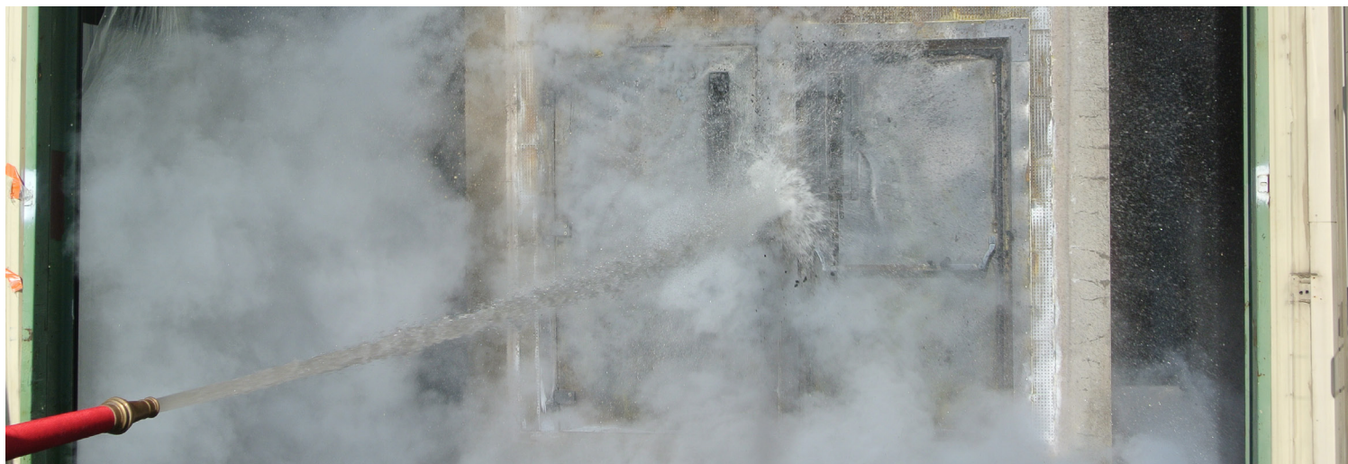
Test «hose stream» réalisé sur un bloc-porte métallique de la société Baumert
