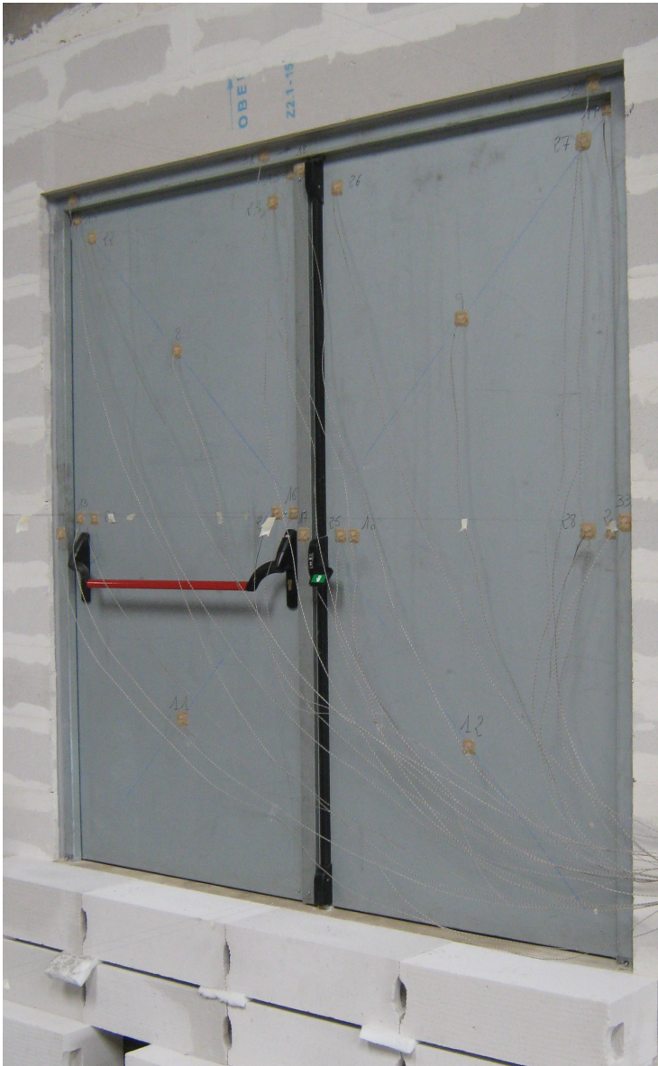
Bloc-porte métallique à deux vantaux battants de la société Portafeu
