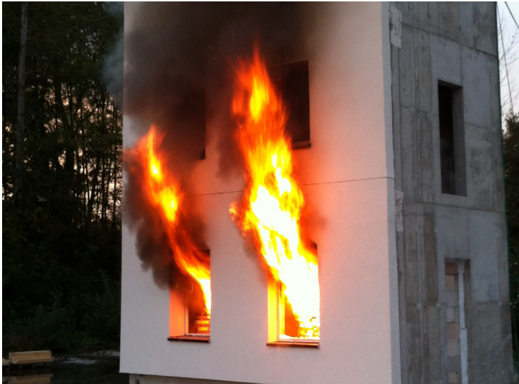
Essai LEPIR II sur façade extérieure en XXX
