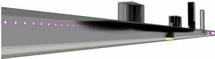
Propagation des fumées dans le caisson TGV de la gare de Massy
