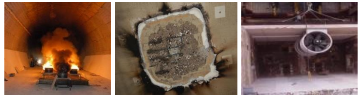
Essais fumées chaudes « in situ », essais d'écaillage au four mobile, essais de résistance au feu en laboratoire d'accélérateurs (jet-fan)
