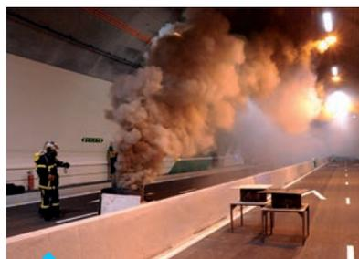
Prova di validazione di un sistema di estrazione del fumo all'interno di tunnel
