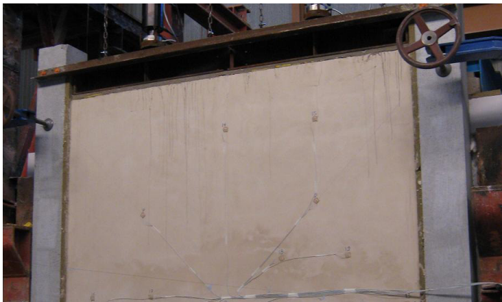
Mur en place sur le four au début de l'essai
