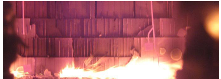
Chute de parois de briques pendant l'essai
