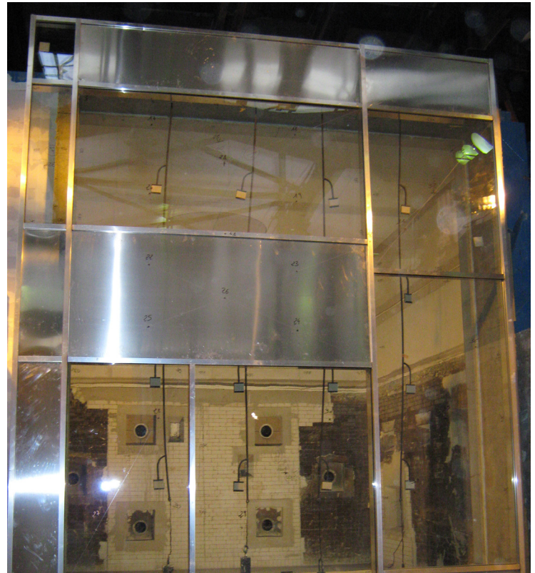
Essai d'une façade vitrée, de dimension 5 x 5 m
