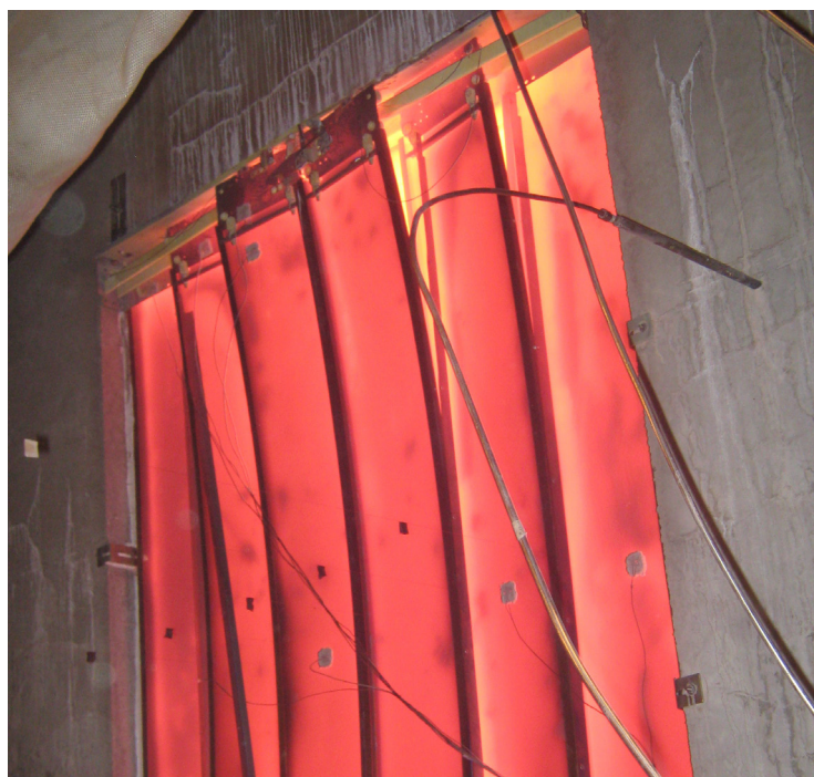
Porte à quatre vantaux métalliques non isolés à ouverture centrale
