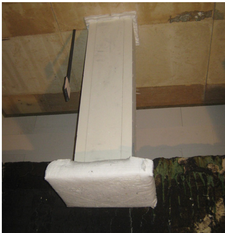
Poteau protégé avant l'essai
