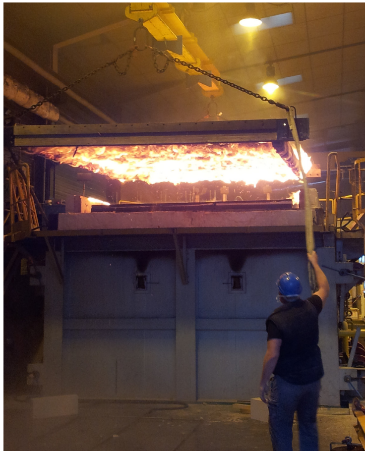
Plancher bois à la fin de l'essai
