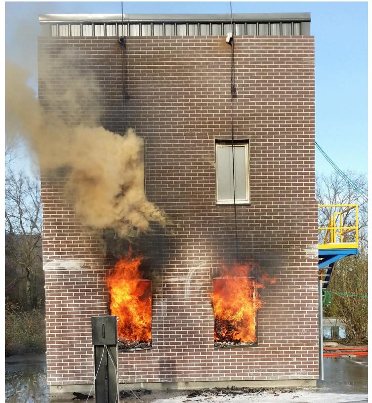
Essai LEPIR II sur façade extérieure en brique
