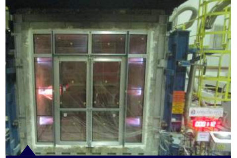
Camlı kapının yangına dayanım testi
