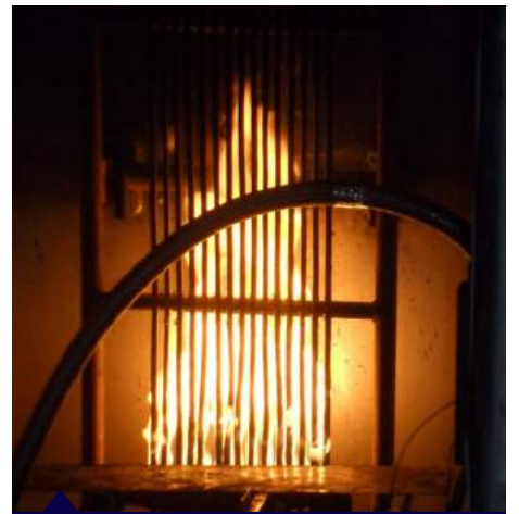
Kabloların yangına tepki testi
