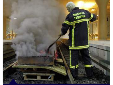
Tren istasyonunda duman tahliyesi
