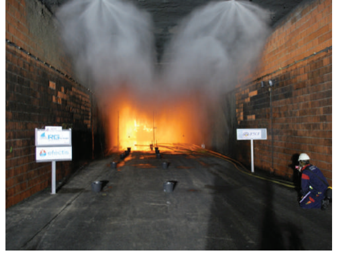
Aktifleştirilmiş su sisi yangın söndürme sistemi
