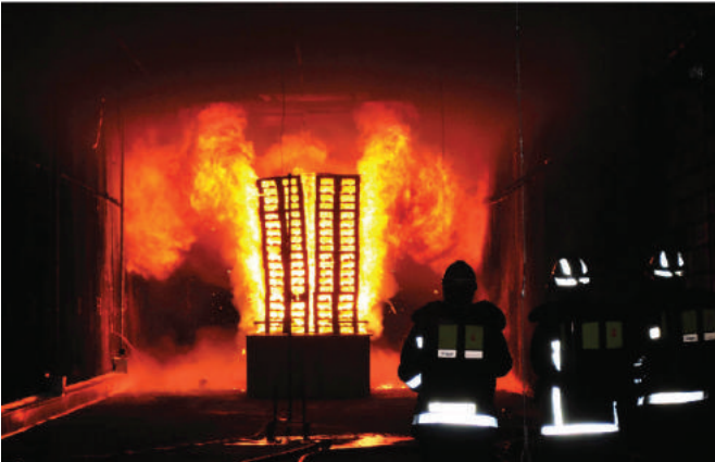
Yangın söndürme sisteminin etkinleştirildiği tam ölçekli tünel yangını
