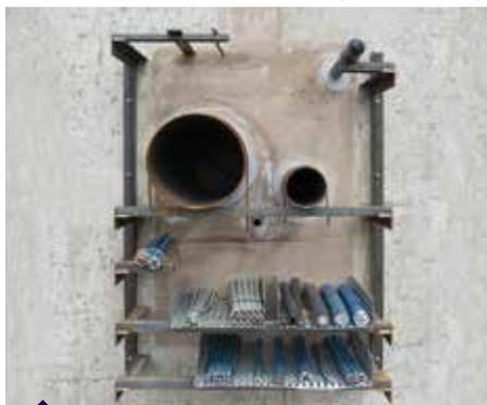
Essai d'étanchéité à l'eau d'une trémie mixte
