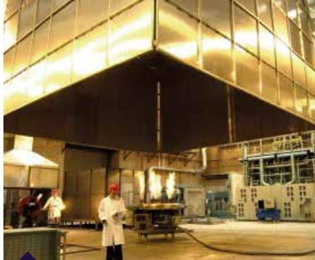
Large hotte calorimétrique 20 MW 9x9x9 m
