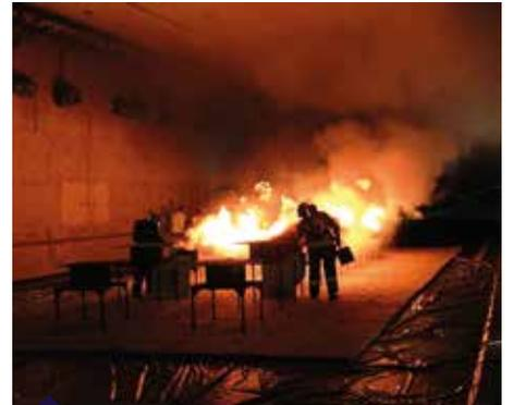
Essai in-situ dans un tunnel (Efectis Outlabs Ventilation)
