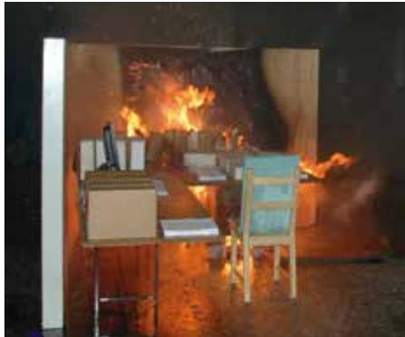
Essai pour des systèmes de brouillard d'eau
