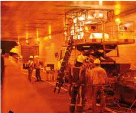
Essai feu en tunnel grâce à notre four MobiFire®
