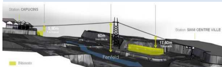
Aperçu du profil en long de l'ouvrage
