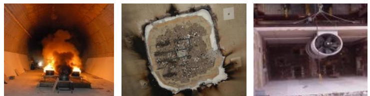
Essai fumées chaudes « in situ », essai d'écaillage au four mobile, essai de résistance au feu en laboratoire d'un accélérateur (jet-fan)
