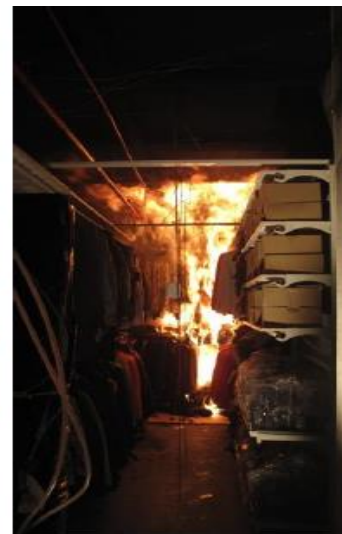
Essais sous hotte calorimétrique de l'incendie d'un stockage de vêtements suspendus
