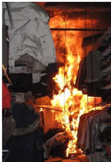
Essais sous hotte calorimétrique de l'incendie d'un stockage de vêtements suspendus
