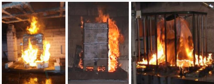
Essais de caractérisation de la combustion de palettes de stockage – Protocole Flumilog
