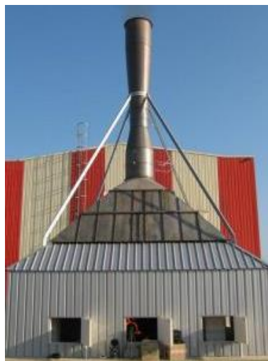
Hotte calorimétrique d'une puissance de 10 MW
