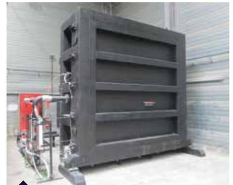
Rauchdichtheitsprüfstand nach EN 1634-3 bis 100 hPa
