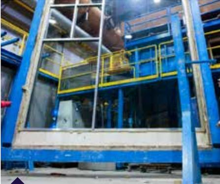
5 Meter x 5 Meter Glasswand als Probekörper
