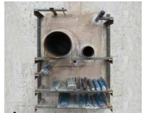
Wasserdichtheitsprüfung von Abschottung
