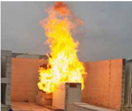
Jet fire Test nach ISO 22899-1
