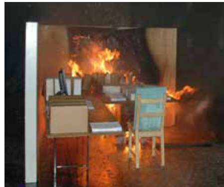
OH1 Prüfung für Wasserebelsysteme
