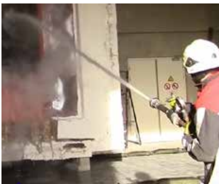
Essai hose stream (3 bar) juste après un essai feu
