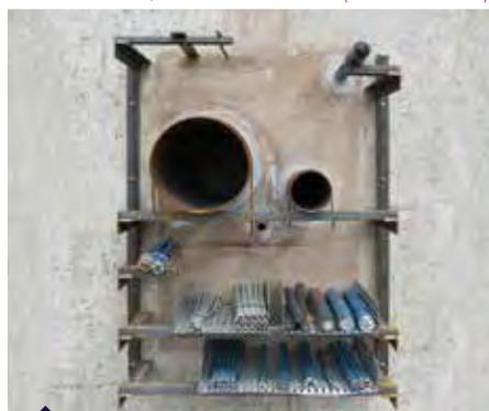
Essai d'étanchéité à l'eau d'une trémie mixte
