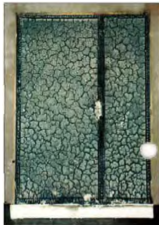
Porte vitrée après essai
