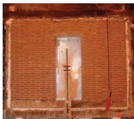
Испытание на огнестойкость туннельной двери напротив вертикальной печи на рабочей площадке Efectis в Нидерландах
