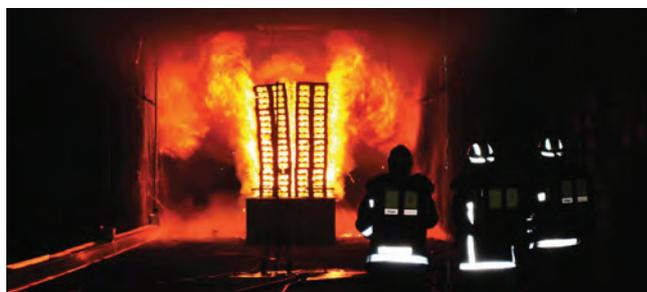
Полномасштабное пожарное испытание в туннеле при помощи активируемой системы дренчерного пожаротушения
