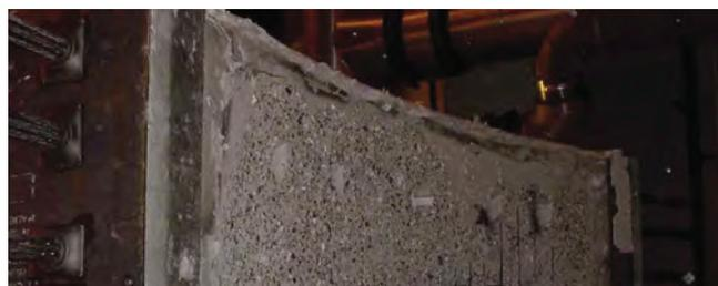
Открытая сторона сегмента туннеля после проведения тестирования на огнестойкость. Из-за сколов бетона видна арматура внутри него
