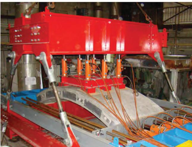
Рама для нагрузки, используемая для противопожарных испытаний в облицованном туннеле
