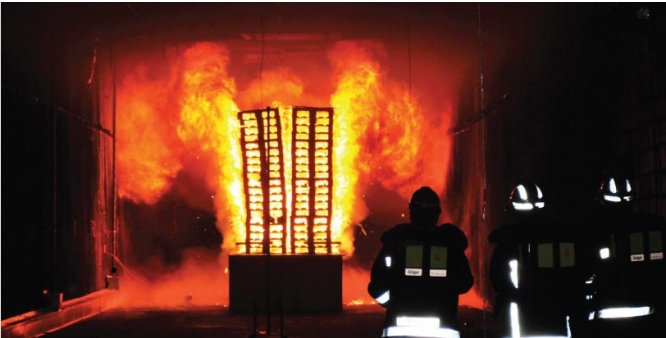
Yangın söndürme sisteminin etkinleştirildiği tam ölçekli tünel yangını
