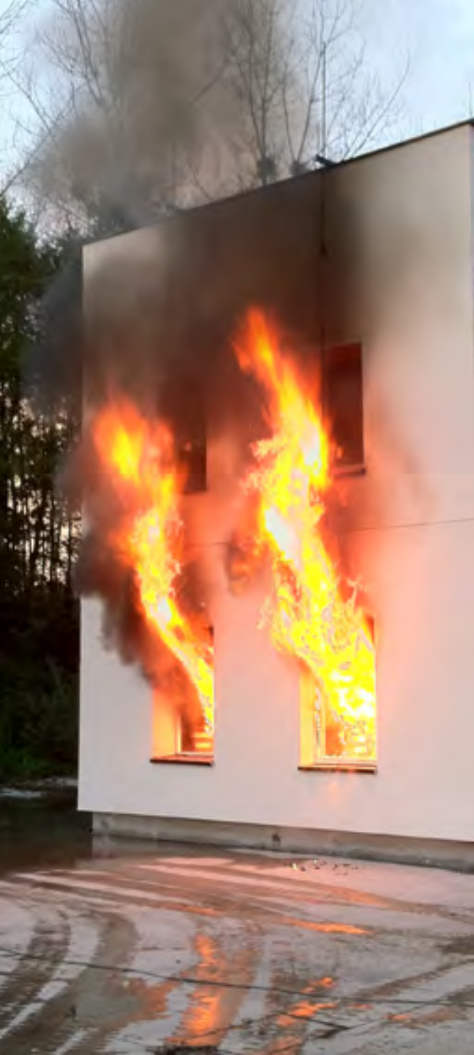
Essai de façade LEPIR2
